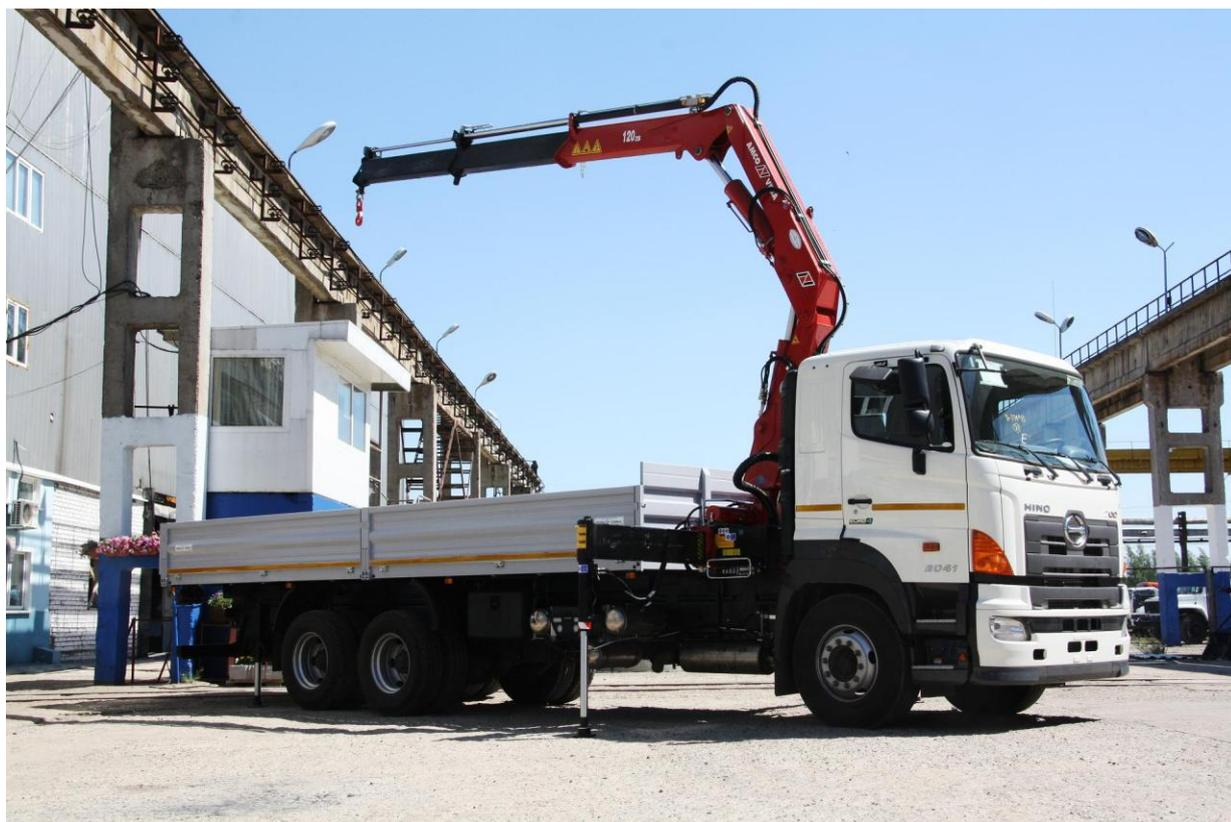
**А/м HINO 700 FS11EUTA-QPR с КМУ Amco Veba 120 2 S (Италия) и с бортовой платформой 8,0x2,5x0,8 с наружными габаритными размерами**
